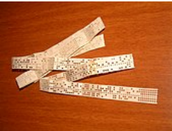
Bande de papier avec des trous représentant des caractères du « code Baudot ».
